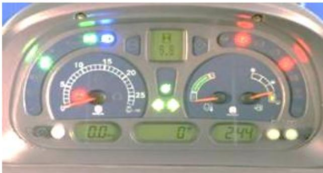
**注：**在钥匙开关打开时，电器开始系统自检，此时所有的报警灯会亮起一段时间。启动拖拉机前，打开钥匙开关后请等待自检结束后再启动发动机，避免拖拉机相关模块数据丢失。
