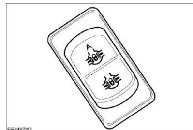
单侧刹车或两侧刹车同时踩下时，可解除手动差速锁。
