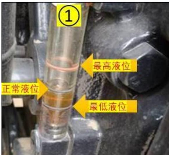
1. 前左、右边检液位：1 位置为加油口，如需放油，行走拖拉机至加油口置于最底部进行排放，AMBRA MULTI G™ 液力传动液压油
