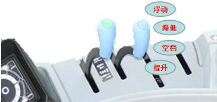
液压远程控制阀可用于操作外部液压油缸、马达等。车辆标配2组液压阀, 可选装第三组远程控制阀
