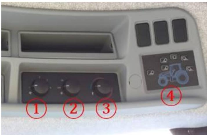
1. 空调风量选择旋钮 2. 空调制冷开关 3. 温度调节旋钮 4. 车辆灯光开关
