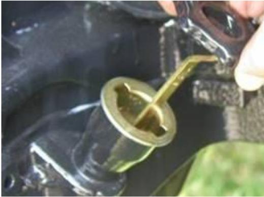
2. 冷却液液位：冷却液要添加纽荷兰 Ambra ACTIFULL OAT 长效冷却液, 请不要与其他品牌混加, 否则可能导致冷却液发生化学反应, 导致结垢, 影响发动机冷却系统
