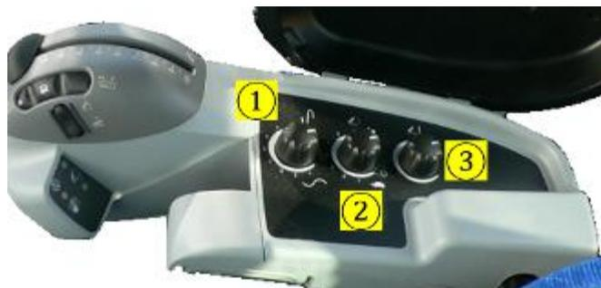
**牵引敏感度旋钮(1)：**提高或降低牵引负荷变化的敏感度，如犁地，敏感度高，犁地深度变化浮动大，敏感度低，犁地深度变化浮动小，顺时针转敏感度加大
