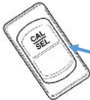
使用扶手右侧校正\选择键切换PTO及悬挂高度位置显示
