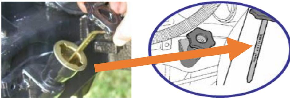
检查机油液位油位应介于油尺的MIN 和MAX 标记之间，约15升。必要时添加更多机油，加油量不要超过油尺上的MAX 指示符。过多的机油会烧掉，产生烟雾并给人以烧机油的错误印象。油位低于油标尺下刻槽时，不要运行发动机。
