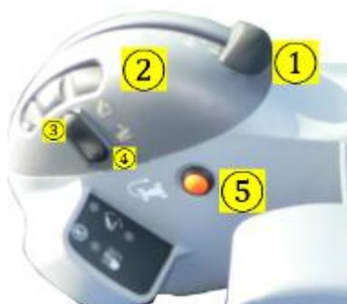
1. 位置调节控制 2. 力控调节制3. 三点悬挂快速上升 4. 三点悬挂快速下降
