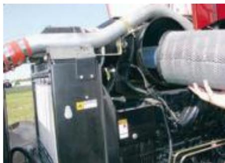
可从发动机右侧检修空气过滤器。
